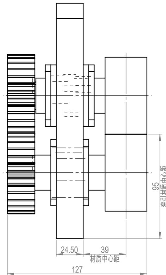
建议选取RV50蜗轮蜗杆减速机
